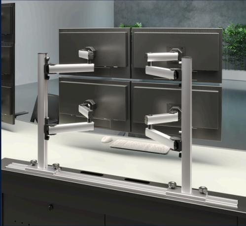
O modelo MF possui um trilho formado por um perfil extrudado em alumínio com acabamento anodizado, fixo na posição horizontal. Esse trilho oferece um encaixe perfeito para a fixação de suportes de monitor, televisores e equipamentos, utilizando manípulos com parafuso martelo e encaixe tipo que permite ajuste longitudinal milimétrico, sem ferramentas, e é autoportante.
